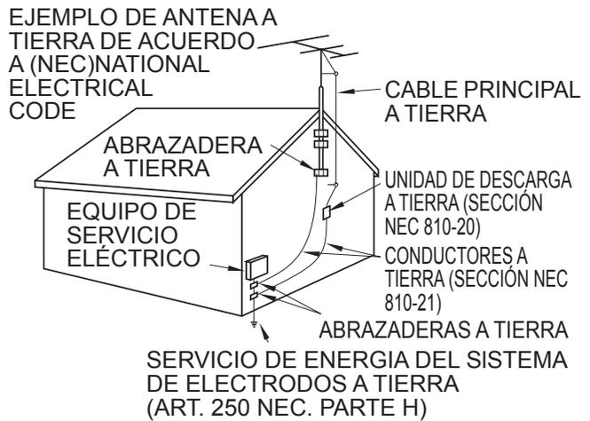
19) Un sistema de antena exterior no deberá ser colocado cerca de las líneas de poder u otros circuitos de energía o luz o donde ésta pueda caer en tales líneas de poder o circuitos. Cuando se instale un sistema de antena exterior, extremar cuidados para evitar tocar tales líneas o circuitos ya que este contacto pudiese tener consecuencias fatales.
