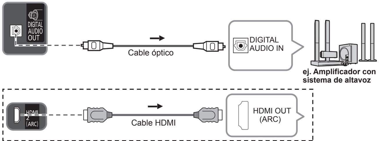
La conexión HDMI está disponible si el equipo de audio conectado tiene la función ARC (Canal de retorno de audio).
