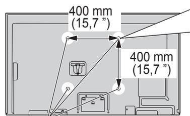
Orificios para la instalación de soportes para montura en pared
