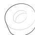
Matériau de protection contre le GPL ou bande de Téflon (pour une installation au gaz)
