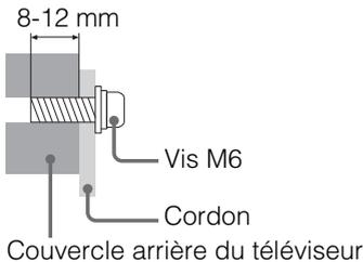
**3** Fixez le téléviseur au mur avec des boulons, un dispositif d'ancrage au mur et une chaîne (ou une corde).
