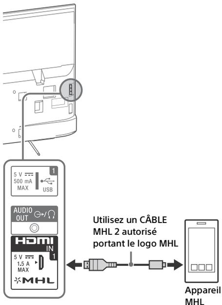
Le téléviseur charge simultanément l'appareil connecté compatible MHL tout en lisant les photos / la musique / les fichiers vidéo. La télécommande du téléviseur peut être utilisée pour contrôler l'appareil connecté compatible avec la fonction MHL.
