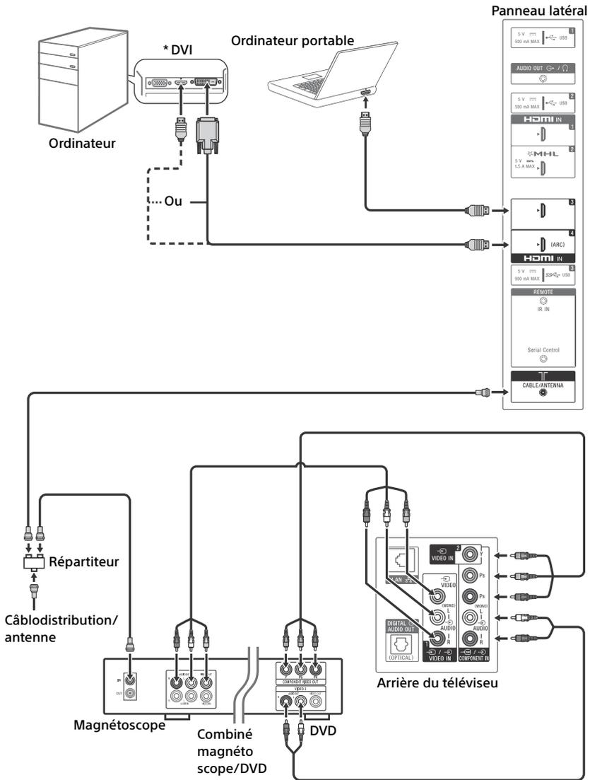
\* La prise DVI ne prend pas en charge les signaux audio. Connecter la sortie audio de l'ordinateur aux enceintes d'ordinateur ou à un récepteur audio-vidéo pour écouter le son de l'ordinateur.
